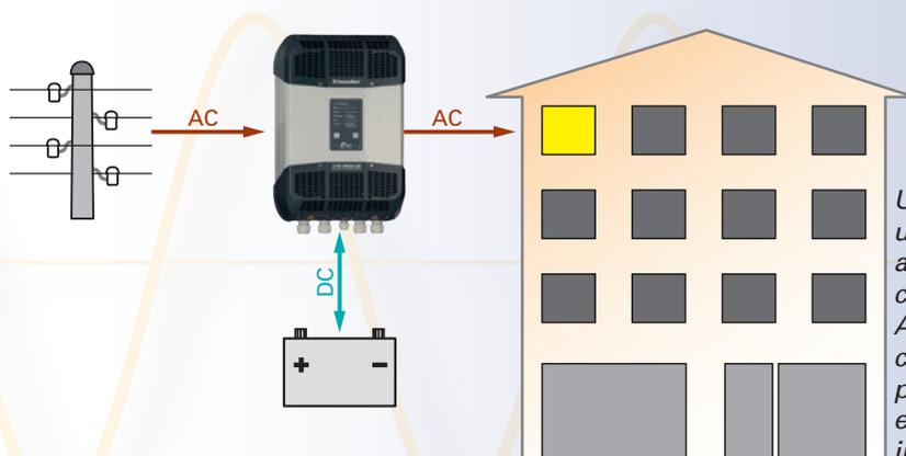
Un onduleur-chargeur est utilisé ici pour fournir une alimentation de secours en cas de panne de réseau. Aussitôt que le courant coupe, l'onduleur-chargeur passe en mode onduleur et assure ainsi une source ininterrompue de courant.
