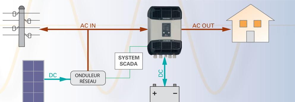
Cette architecture présente l'avantage d'être aisément intégrable à une installation existante d'injection réseau même si celle-ci est de puissance supérieure à la puissance de l'Xtender. L'optimisation de l'autoconsommation est réalisée par un système expert (SCADA) fourni par les différents partenaires de Studer Innotec. Le système permet également l'établissement d'un réseau secouru séparé adapté aux seuls besoins de sécurisation (par exemple illumination, systèmes de froid et communication).
