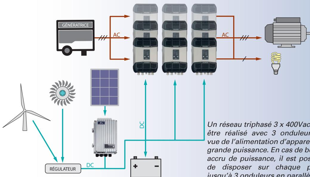
Un réseau triphasé 3 x 400Vac peut être réalisé avec 3 onduleurs en vue de l'alimentation d'appareils de grande puissance. En cas de besoin accru de puissance, il est possible de disposer sur chaque phase jusqu'à 3 onduleurs en parallèle.
