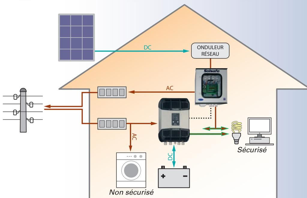
L'installation de la solution Solsafe dans un système solaire raccordé au réseau permet de sécuriser tout ou partie de l'alimentation électrique en cas de panne du réseau, et d'exploiter ainsi l'énergie solaire produite (**Note d'application AN003/www.studer-innotec.com**).
