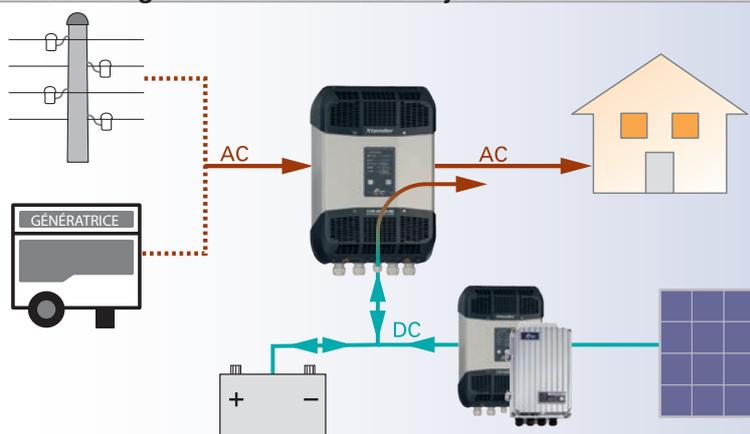
Lorsqu'il est interdit ou peu incitatif d'injecter l'énergie dans le réseau, l'Xtender accompagné du VarioTrack/VarioString permettra de minimiser la part consommée du réseau en utilisant en priorité l'énergie produite localement. Il permet également de garantir la fourniture d'énergie même en cas de coupure du réseau. Une solution simple à mettre en œuvre avec des composants Studer.
