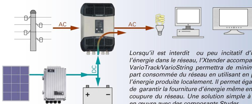
Lorsqu'il est interdit ou peu incitatif d'injecter l'énergie dans le réseau, l'Xtender accompagné du VarioTrack/VarioString permettra de minimiser la part consommée du réseau en utilisant en priorité l'énergie produite localement. Il permet également de garantir la fourniture d'énergie même en cas de coupure du réseau. Une solution simple à mettre en œuvre avec des composants Studer.
