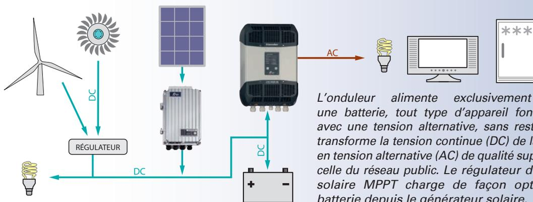
L'onduleur alimente exclusivement depuis une batterie, tout type d'appareil fonctionnant avec une tension alternative, sans restriction. Il transforme la tension continue (DC) de la batterie en tension alternative (AC) de qualité supérieure à celle du réseau public. Le régulateur de charge solaire MPPT charge de façon optimale la batterie depuis le générateur solaire.
