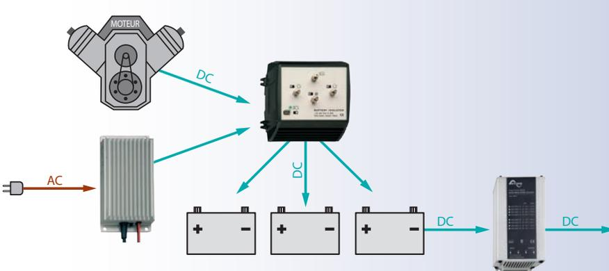
Un répartiteur à MOSFET, aux pertes quasi nulles, permet de répartir un courant de charge vers plusieurs batteries. A partir du parc de batteries, un convertisseur DC/DC va élever ou abaisser la tension en fonction de celle d'utilisateurs 12 ou 24Vdc.
