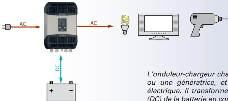
L'onduleur-chargeur charge la batterie depuis le réseau ou une génératrice, et alimente tout type d'appareil électrique. Il transforme par ailleurs le courant continu (DC) de la batterie en courant alternatif (AC).
