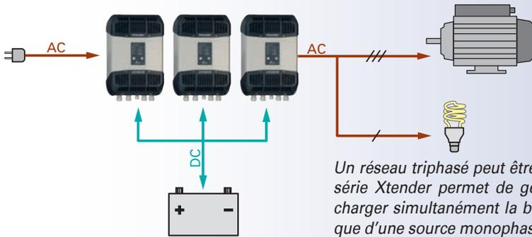
Un réseau triphasé peut être réalisé avec trois onduleurs. La série Xtender permet de générer un réseau triphasé et de charger simultanément la batterie, même si l'on ne dispose que d'une source monophasée.
