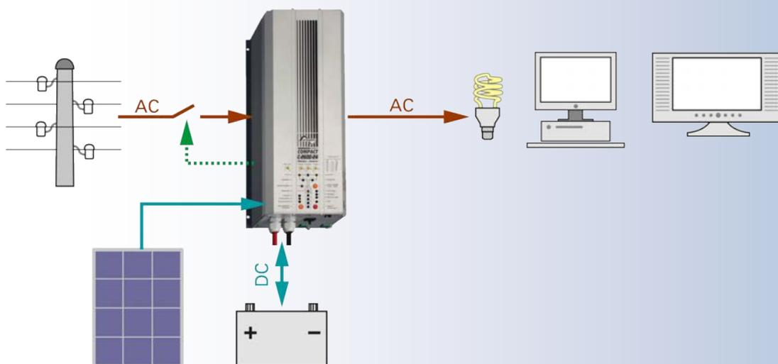
Les onduleurs/chargeurs des séries Compact avec régulateur solaire intégré (ou externe) permettent de réaliser un système de secours avec priorité solaire. Les utilisateurs consomment l'énergie solaire tant qu'il y en a assez dans le système. Lorsque la batterie passe en-dessous d'un certain niveau, c'est le réseau public qui est alors sollicité.
