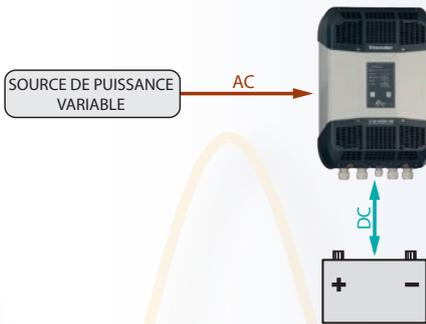
La source étant un alternateur à puissance variable, le Smart-boost va fournir la différence de puissance afin que la puissance délivrée soit toujours la même (Note d'application AN004/[www.studer-innotec.com](http://www.studer-innotec.com)).
