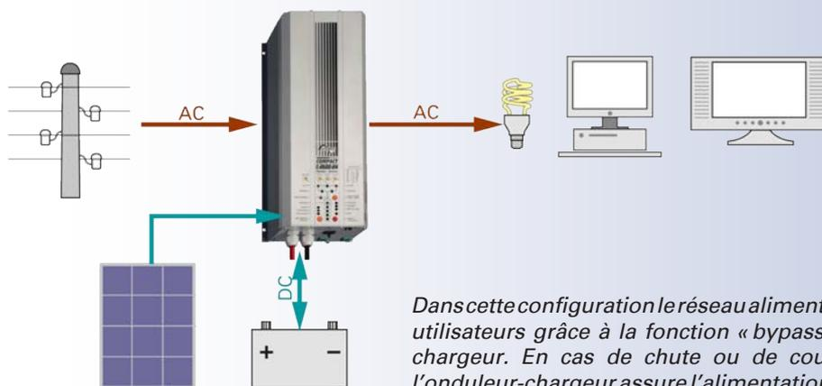
Dans cette configuration le réseau alimente directement les utilisateurs grâce à la fonction « bypass » de l'onduleur-chargeur. En cas de chute ou de coupure du réseau l'onduleur-chargeur assure l'alimentation des utilisateurs.
