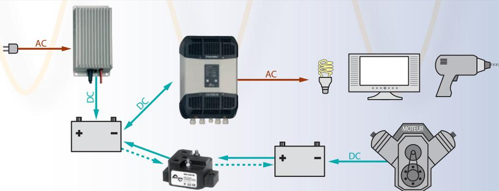
Dans ce système, un séparateur de batterie permet la charge de la (des) batterie(s) auxiliaire(s) une fois que la batterie primaire est chargée.
