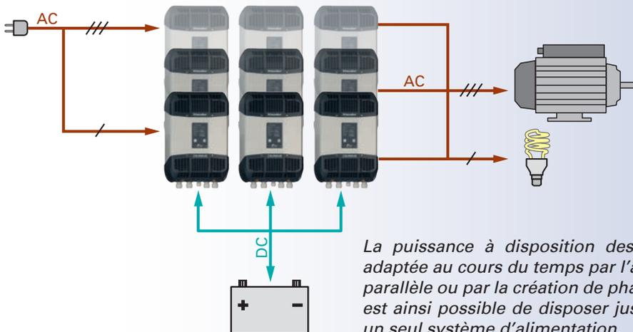
La puissance à disposition des utilisateurs peut être adaptée au cours du temps par l'addition d'onduleurs en parallèle ou par la création de phases supplémentaires. Il est ainsi possible de disposer jusqu'à 9 onduleurs dans un seul système d'alimentation.
