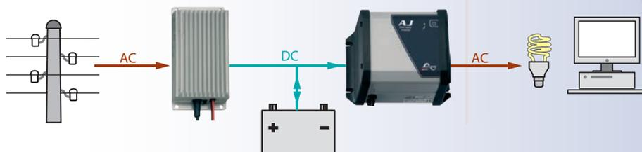
Dans ce système les fonctions de charge de la batterie et d'alimentation des appareils sont séparées, avec d'un côté un chargeur de batterie et de l'autre un onduleur. Les fluctuations du réseau n'ont aucune incidence sur les utilisateurs.
