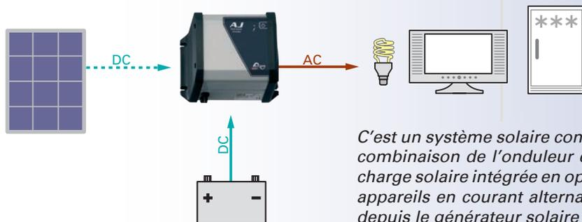
C'est un système solaire complet que permet d'obtenir la combinaison de l'onduleur et la fonction de contrôle de charge solaire intégrée en option. L'onduleur alimente les appareils en courant alternatif (AC) et charge la batterie depuis le générateur solaire (DC).
